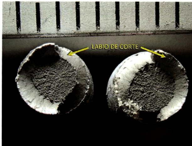
Figura 120. Vista en planta de la cara de fractura producida por una sobrecarga simple durante un ensayo de tracción de un alambre de tendón.
