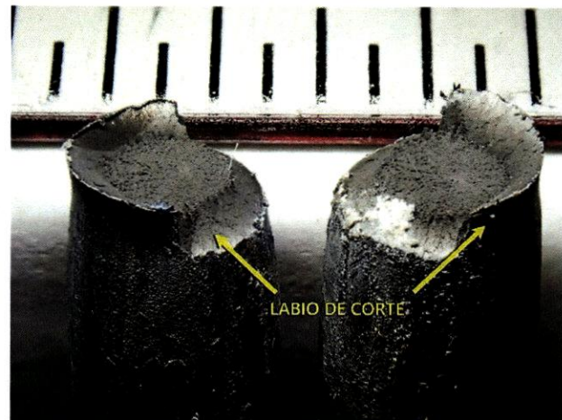
Figura 121. Vista oblicua de la cara de fractura producida por una sobrecarga simple durante un ensayo de tracción de un alambre de tendón.
