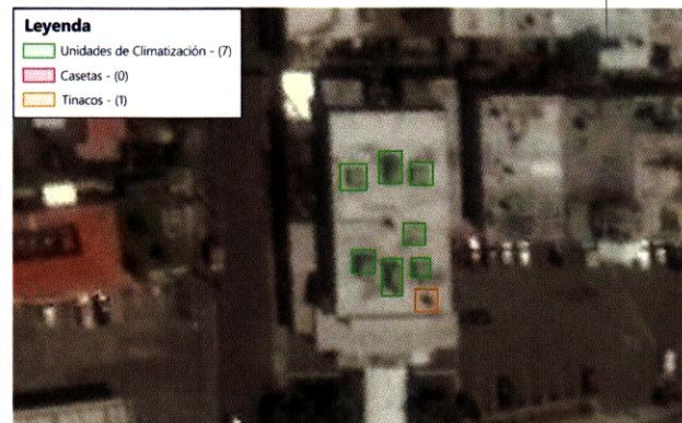
Figura 59. Imagen aérea del techo del Jet Set, de junio de 2013, proporcionada por Google Earth. Anotaciones realizadas según se indica en la leyenda.
