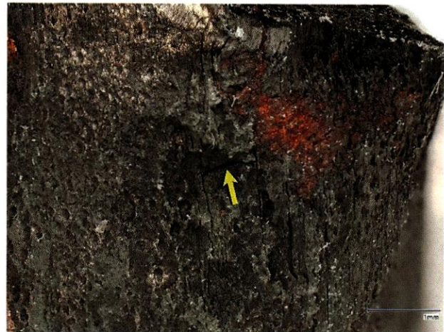
Figura 115. Grieta secundaria en el alambre de F-A-BM-9.
