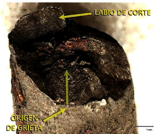
Figura 123. Cara del alambre fracturado No. 2 de F-A-BM-12.
