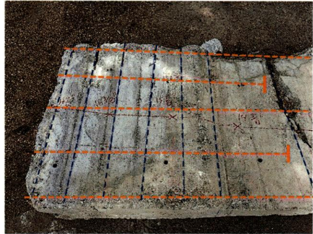
Figura 81. Configuración típica del refuerzo en el extremo de la viga en el espécimen F-A-BM-4. El refuerzo longitudinal se muestra mediante líneas discontinuas en color naranja. Los estribos se muestran mediante líneas discontinuas en color azul.
