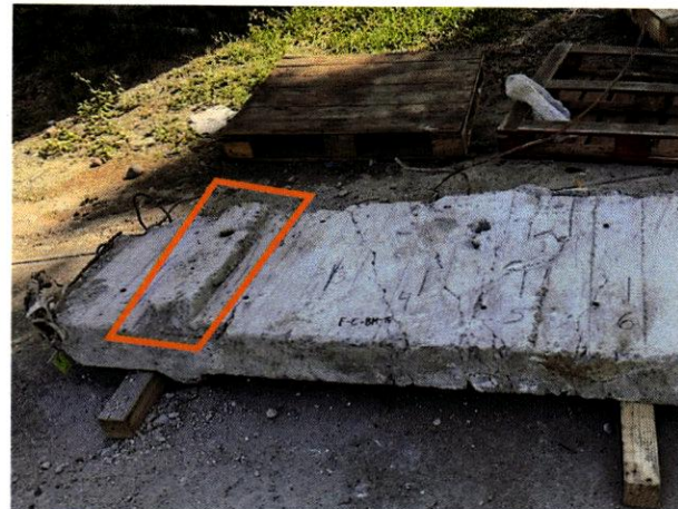
Figura 83. Resalto típico del diafragma en el centro del vano de la viga, identificado en el espécimen de viga F-C-BM-15 (recuadro en naranja).
